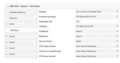
Mit diesem Profil können verschiedene bidirektionale EnOcean-Schalt- oder Dimmaktoren dieser EEP-Familie benutzt werden.
