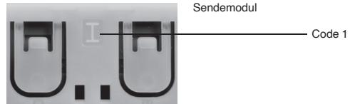
**⚠️** Zum Einstellen von Sonderfunktionen/Modus am Empfänger muss die Position von Code I/O am Sender bekannt sein.
