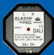
DALI-Controller UP / Easy Art.-Nr. 300501 E-Nr.: Einlernen direkt via Funktaster Bis 15 Slaves
