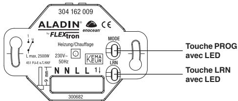
Le récepteur doit être en permanence sous tension. Les pics de tension/courant lors de l'enclenchement/déclenchement doivent être réduits en amont dans l'installation.
