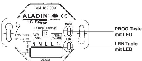
Der Empfänger muss bei einer konstanten Betriebsspannung betrieben werden. Strom-/Spannungsspitzen beim Ein-/Ausschalten der Versorgungsspannung müssen bauseits vermieden werden.
